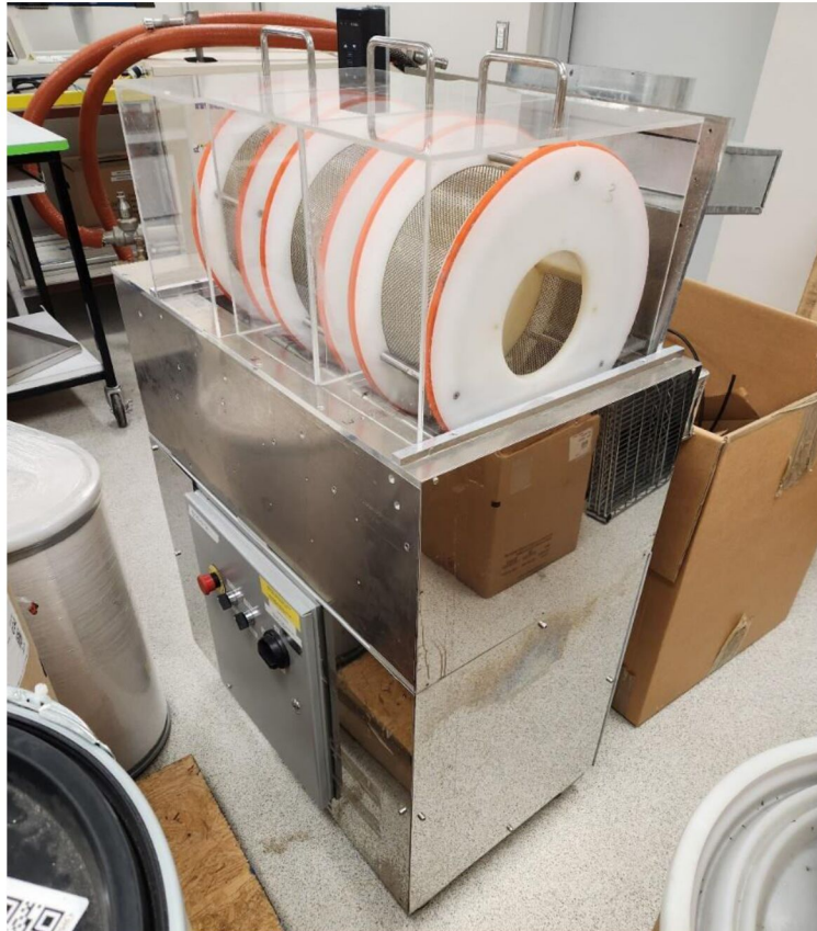
Figura 1 – Imagem do equipamento secador rotativo de cápsulas moles por tombamento com soprador de ar
